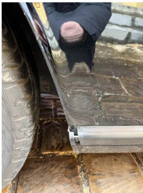
ACCASTILLAGE ARD Défaut d'alignement
