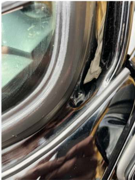
BAIE DE PARE BRISE Ouverture dans la peinture, risque d'apparition d'un point de rouille. A traiter
